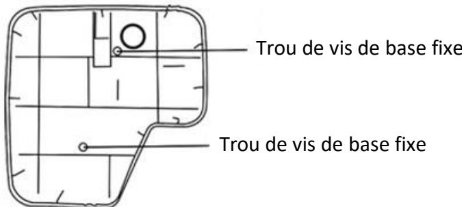
1. Desserrez les vis pour retirer la plaque arrière du capot avant et utilisez-le comme gabarit pour marquer les deux trous à percer.
