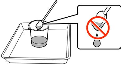
Ao embeber um limpador com limpador de tinta, use o limpador de tinta colocado no recipiente.
