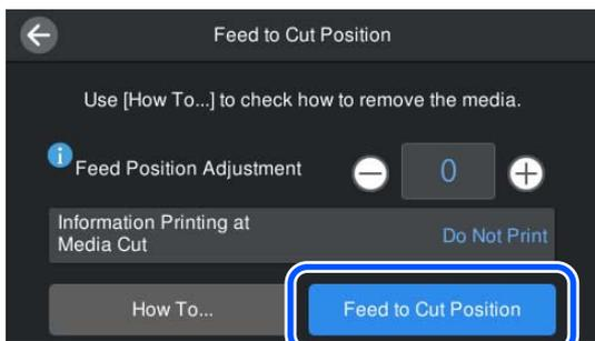
Alterar o **Ajuste da posição de alimentação** permite ajustar a taxa de avanço em relação ao valor padrão. Se você quiser ajustar as margens dos resultados de impressão, ajuste a posição de alimentação e pressione **Alimentação para posição de corte**.
