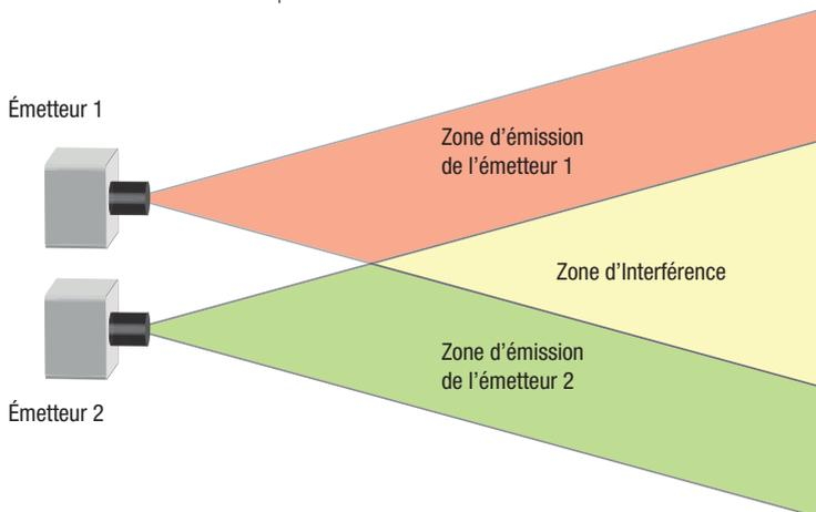
Si on place un récepteur dans la zone d'interférence, on pourra dresser une « carte » des maxima et dessiner progressivement, et point par point, les franges.
