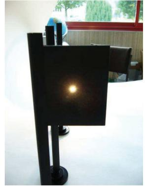
Une fois ces écrans bien positionnés, l'élève fera passer le fil au travers des 3 trous. En tendant le fil, il va constater que les trous sont parfaitement alignés. Il pourra conclure que la lumière se propage en ligne droite.
