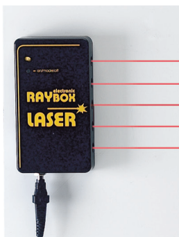
1 er mode : les faisceaux 1, 2, 3, 4 et 5 sont visibles.
